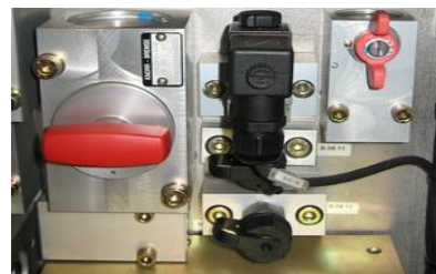
Slika 17: Pipa glavnih rezervoarjev v položaju »motnja«
