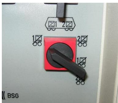
Slika 34: Stikalo motenj ASG v položaju ASG1 »izklop«
