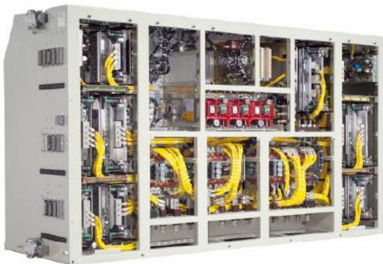
Slika 33: Vlečni pretvornik toka SR
