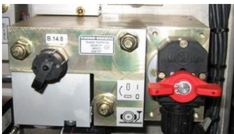
Slika 16: Zaporna pipa peskanja v položaju »izključeno«
