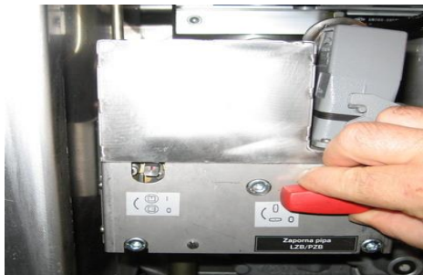
Slika 98: Zaporna pipa (ASN) LZB/PZB (zavorni modul v strojnici) v položaju »izključeno«
