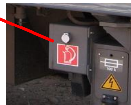
Slika 118: Naprava za gašenje požara – posluževanje na zunanji strani lokomotive
