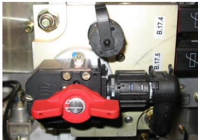
Slika 22: Pipa motenj direktne zavore v položaju »motnja« (vodoravno)
