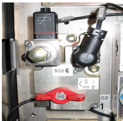
Slika 26: Zaporna pipa ZHZ v položaju »izključeno«
