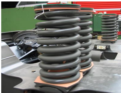
Slika 11: Sekundarne vzmeti
